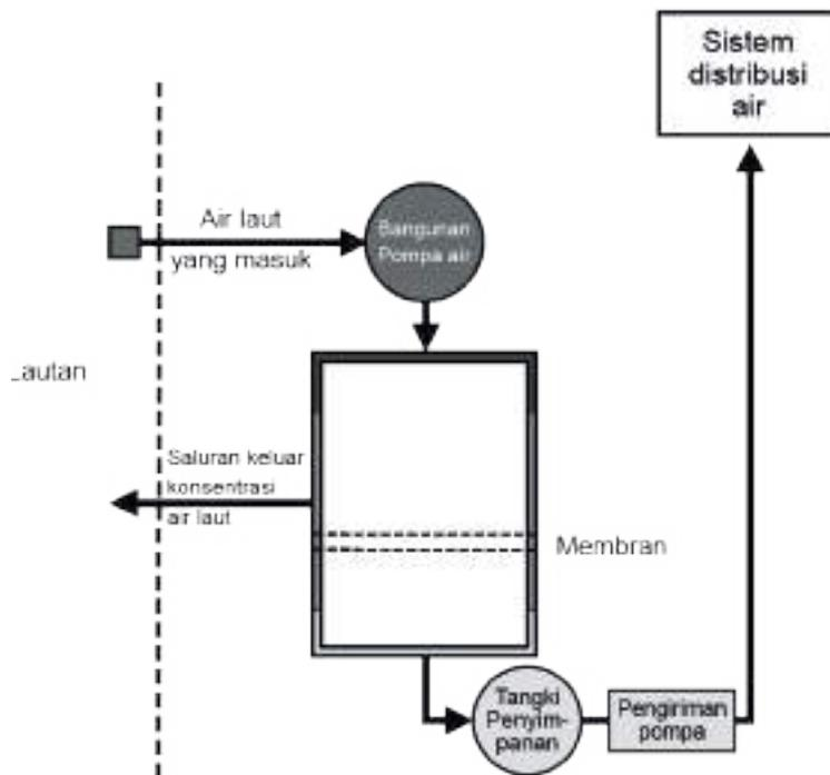
Perhatikan gambar di atas! Salah satu cara untuk memproduksi air minum dari air laut adalah dengan cara menerapkan prinsip osmosis terbalik. Osmosis terbalik merupakan salah satu tipe filtrasi. Air laut didorong masuk melalui membran semipermeabel dengan pemberian tekanan oleh alat pemompa (*pumping station*).
